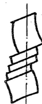
Figura 3: Schema de alunecare a unui cristal.
